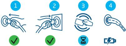
Abbildung 2.4: Starten des Ladevorgangs mit Benutzerberechtigung/Ladekarte. Auf der Benutzeroberfläche angezeigte Symbole
