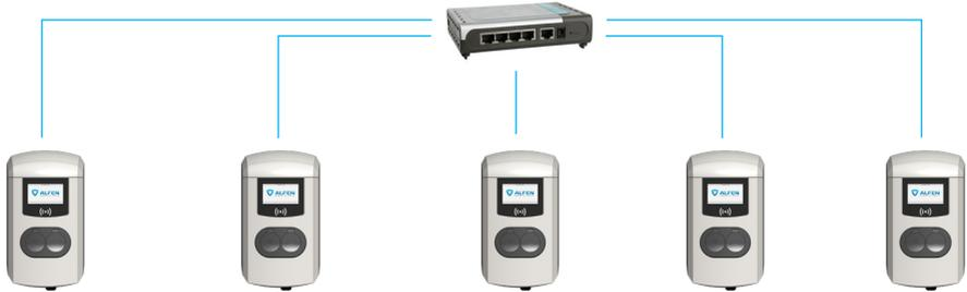
Figura 8: red de carga inteligente con modelos Eve Double Pro-line
