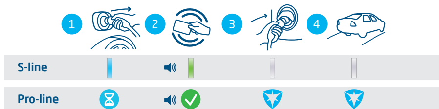
Figura 4.6: Arresto del processo di ricarica. Simboli mostrati sull'interfaccia utente
