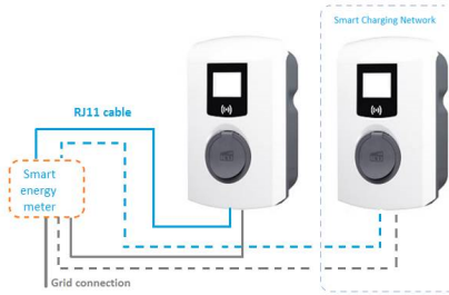
Figuur 5.2: Actieve laadbalans met energiemeter (P1-poort)
