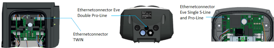
Figuur 5.15: Locaties van ethernet aansluiting
